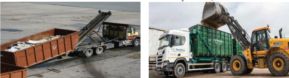
الشكل 5-2: رسم توضيحي لتحميل نفايات البناء والهدم
