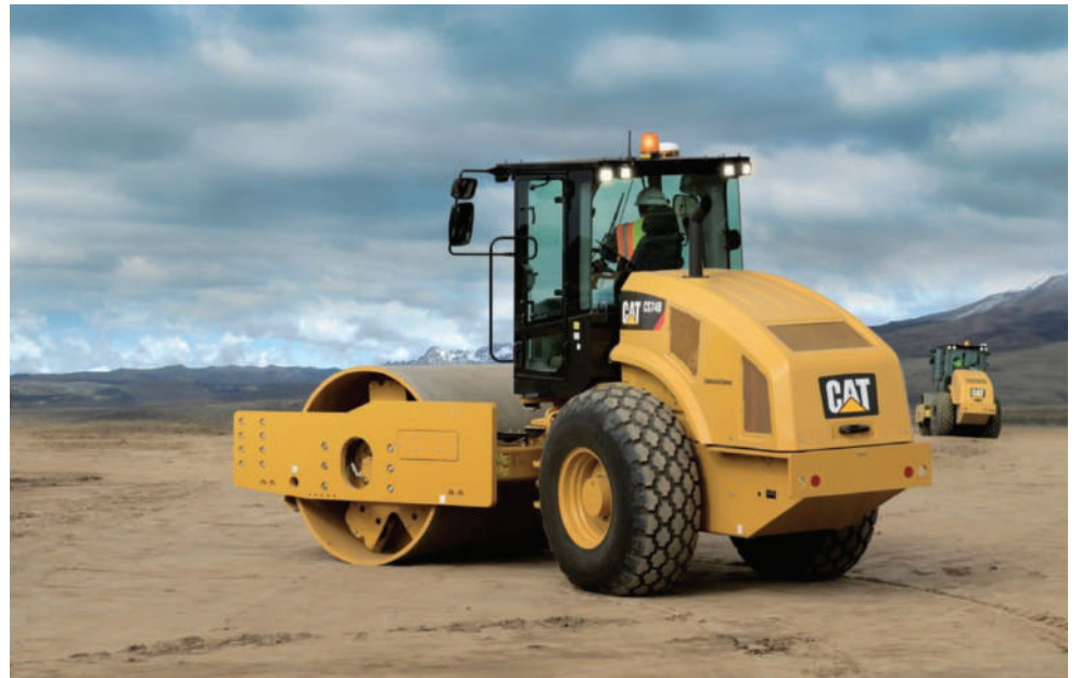
الشكل 7-5: رسم توضيحي لعملية دمك نفايات البناء والهدم في الخلية المخصصة
